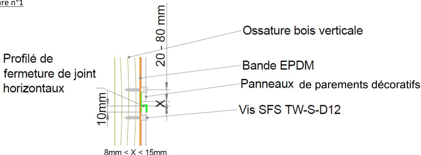
Figure 20.1 – Joint horizontal fermé COB supérieure à R+2
